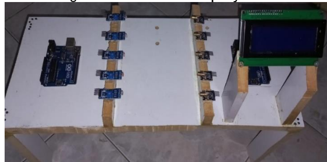
Figura 5: Inclusão do display LCD
